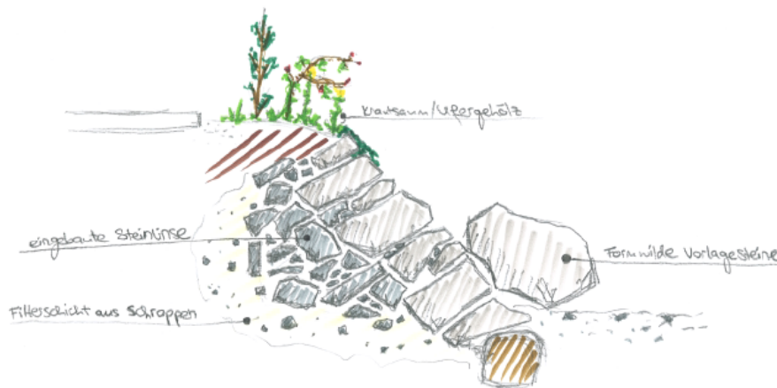
Abbildung 44 Schematische Darstellung schräge Ufermauer mit Steinlinsen.
