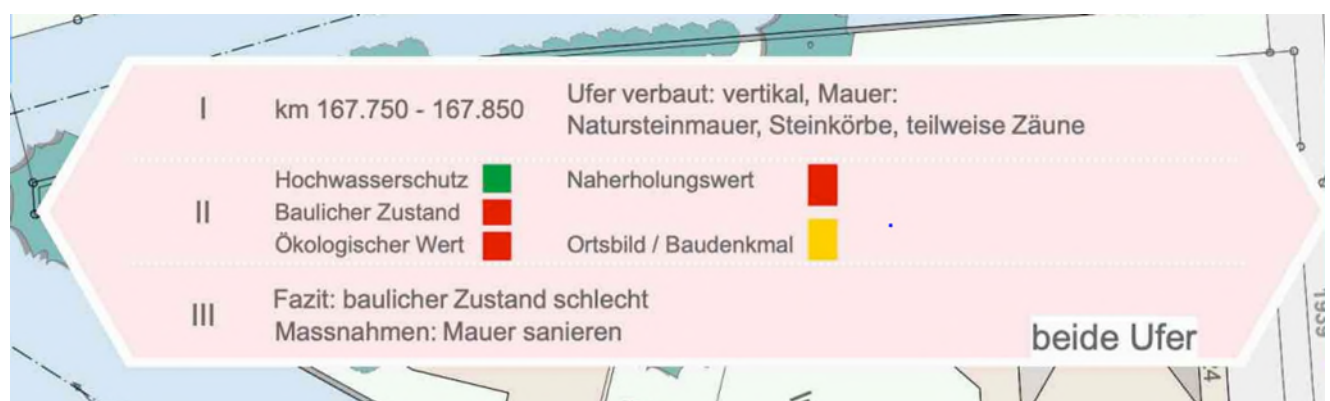
Abbildung 31 Darstellungsbispiel aus dem Sanierungskonzept, rot eingefärbt, da ein Handlungsbedarf besteht
